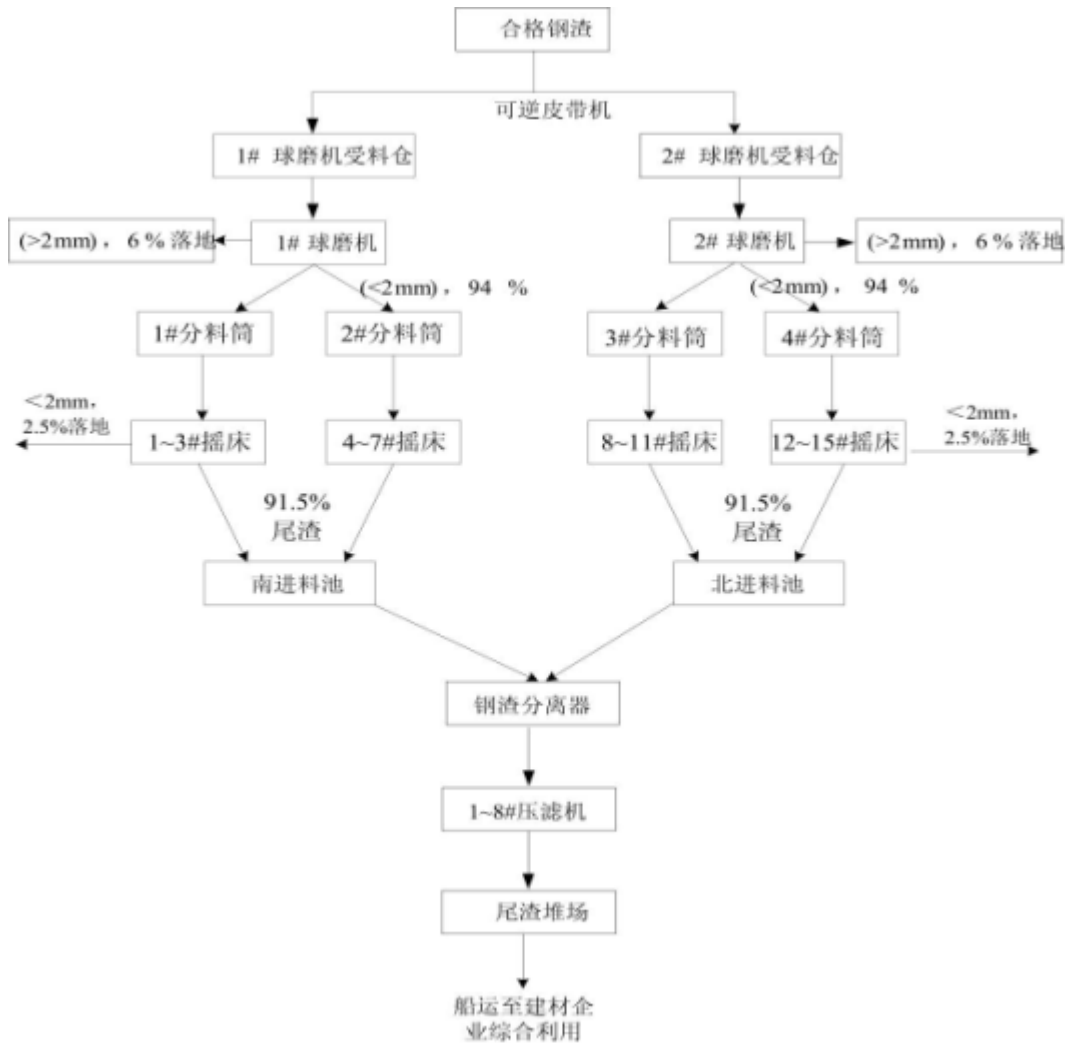
图 2-9 钢渣二次处理（精选）工艺流程图
